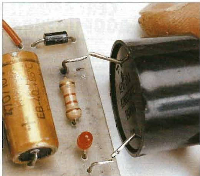
**Il buzzer si può saldare direttamente alla basetta o montare su un eventuale contenitore del circuito collegandolo con cavetti schermati.**
