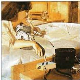
**Il temporizzatore di rete** è un dispositivo molto utile che consente di far accendere e spegnere un qualsiasi apparecchio in un tempo regolabile da 1 a 10 minuti.
