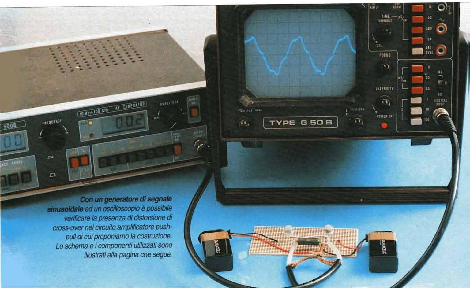
*Con un generatore di segnale sinusoidale ed un oscilloscopio è possibile verificare la presenza di distorsione di cross-over nel circuito amplificatore push-pull di cui proponiamo la costruzione. Lo schema e i componenti utilizzati sono illustrati alla pagina che segue.*
