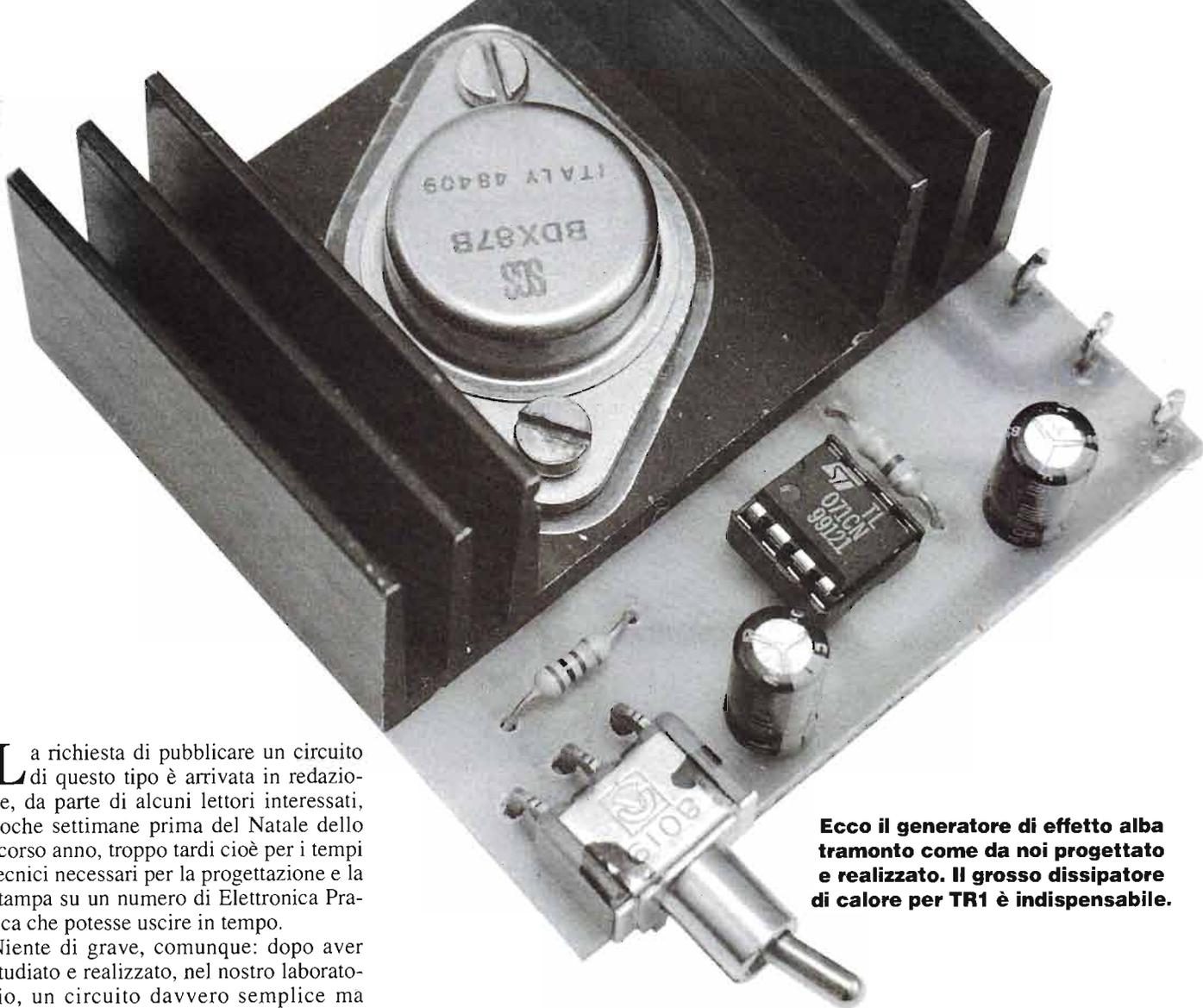
**Ecco il generatore di effetto alba tramonto come da noi progettato e realizzato. Il grosso dissipatore di calore per TR1 è indispensabile.**
